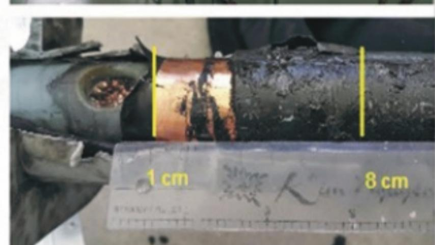
Kích thước bán dẫn chỉ là 1cm so với 3cm theo hướng dẫn. Với kích thước ngắn như vậy khi quấn băng vinyl che lớp bìa đồng sẽ che gần như hết lớp bán dẫn này, khiến cho điều áp không tiếp xúc được với bán dẫn nhiều so với thiết kế của đầu QTII. Mặc dù không thể phản bác được điểm này, nhưng KH vẫn vin vào lý do điều áp vẫn nằm trên bán dẫn.
