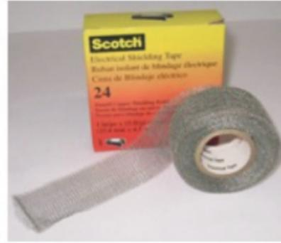
Màn chắn kim loại của cáp được thay thế bằng một lưới dệt linh hoạt bằng đồng mạ thiếc. Lớp lưới đồng này chỉ có tác dụng tạo màn chắn điện áp, và không có tác dụng để mang dòng tải. Dòng tải qua màn chắn 2 bên cáp được nối bằng một sợi dây đồng đấu nối với hệ thống màn chắn của cáp.
